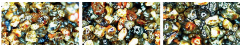
Рис. 3. Загрязнение крупного песка, загрязняющее вещество тяжелая нефть: a – концентрации 2 %; б – концентрации 6 %; в – концентрации 12 %.
