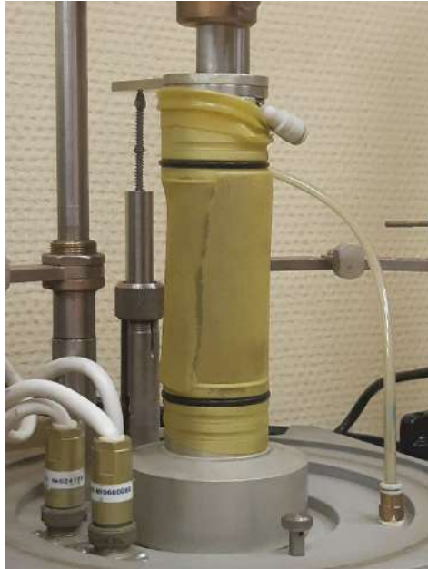
Рис. 3. Опытный образец после испытания в приборе трехосного сжатия
