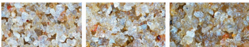
Рис. 3. Загрязнение крупного песка, загрязняющее вещество тяжелая нефть: a – концентрации 2 %; б – концентрации 6 %; в – концентрации 12 %.
