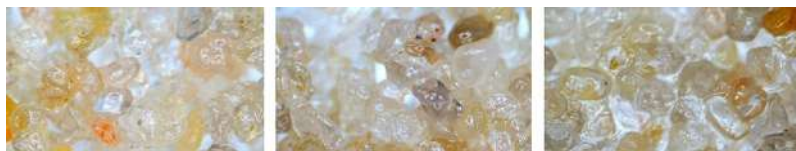
Рис. 1. Загрязнение крупного песка, загрязняющее вещество дизель: а – концентрации 2 %; б – концентрации 6 %; в – концентрации 12 %
