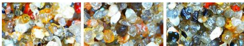
Рис. 1. Загрязнение крупного песка, загрязняющее вещество дизель: а – концентрации 2 %; б – концентрации 6 %; в – концентрации 12 %
