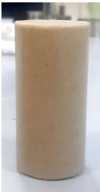
Рис. 2. Опытный образец до испытания в приборе трехосного сжатия
