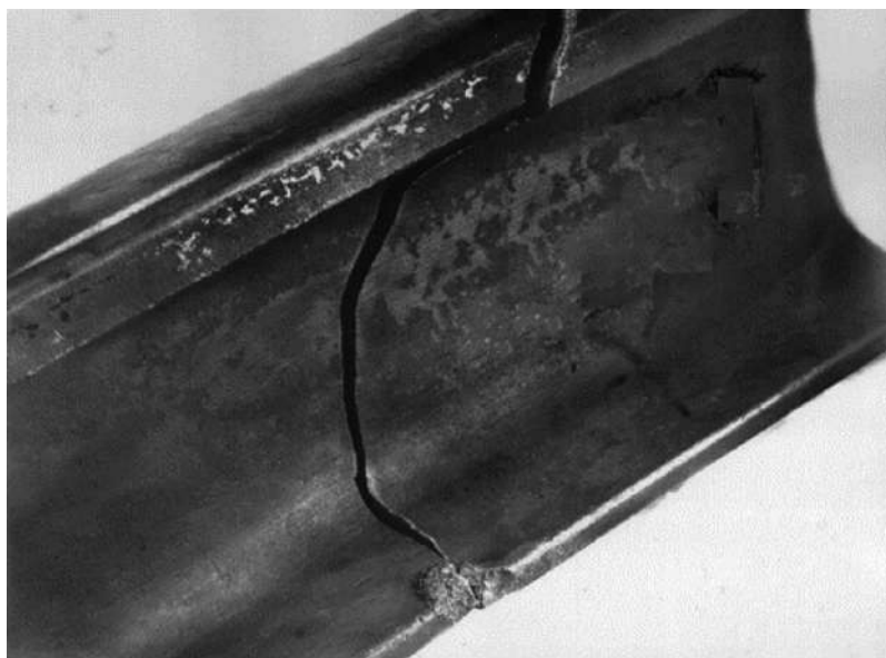
Рис. 1. Хрупкое разрушение стальной конструкции
