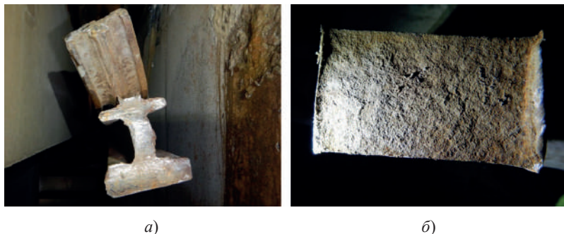
Рис. 2. Усталостный излом ламели (а) модульного деформационного шва с последующим хрупким разрушением траверсы (б)
