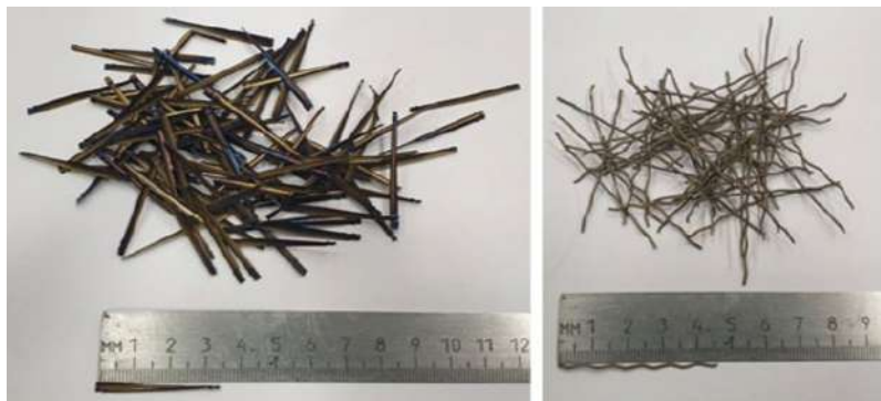
Рис. 3. Используемые в исследовании волокна: слева – фрезерная фибра; справа – проволочная фибра
