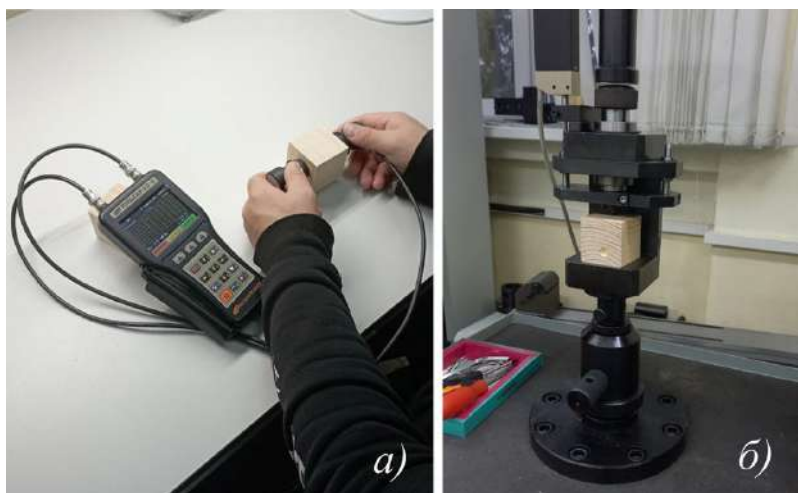
Рис. 2. Проведение измерений по определению: а – скорости ультразвуковых колебаний; б – статической твердости
